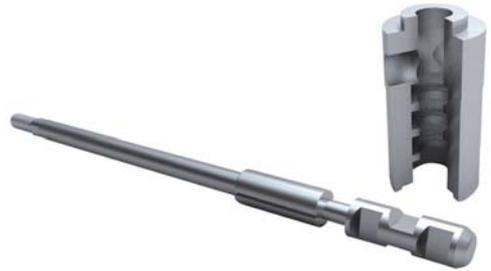
maze<sup>®</sup>300调节阀的阀芯提供了独特配置设计，采用一系列相同降压级来控制侵蚀，并在末级扩容来降低潜在的气蚀。在严酷工况下，控制流速和大大延长了阀芯的使用寿命。由于较大的流道及串式阀芯和阀笼设计的剪切作用，这类阀门特别适用于含有颗粒、粉尘、结晶等杂质的流体，在运动过程中具有显著的自清洁功能。有效的节流解决方案提供了相对较小的Cv值。简单的阀内件结构便于维护检修，还可以方便地根据客户的特殊需求进行个性化的设计。选用不同级数的阀芯结构可以满足压缩气体、两相流和闪蒸等工况。
